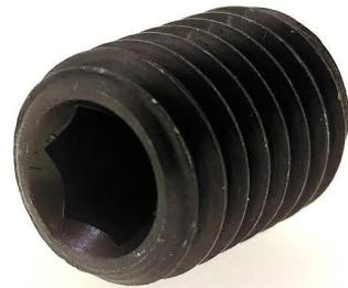
精度・硬度が高く韌性があるため、六角レンチがねじ切れるまで締め付けても、六角穴は回ったり割れたりしません。六角穴にマグネットを近づけるとねじ切れたスパナーがマグネットに吸着され、六角穴から引き出されます。
